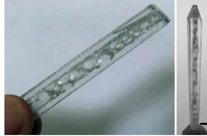
Рис. 25 Два кристалла ВГК, выращенные во фторидных (бесщелочных) растворах на затравках, параллельных грани s\{11-21\} . Затравка подвержена «сотовой» трещиноватости. Причины возникновения трещин объяснены в тексте.
